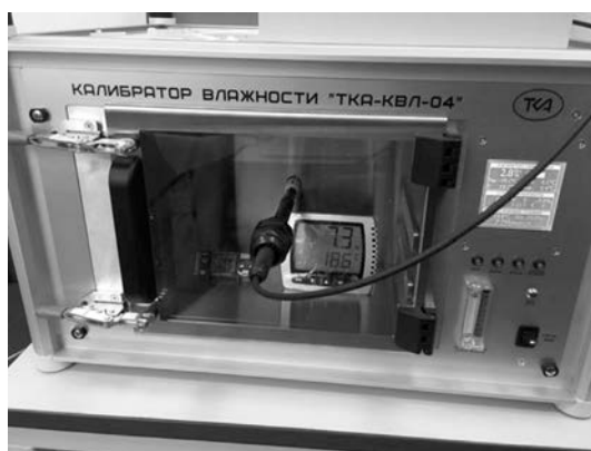
Рис. 3. Калибратор влажности «ТКА-КВЛ-04-1» с установленным зондом эталонного термогигрометра
