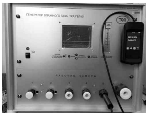
Рис. 5. Термогигрометр эталонный ТКА-ТВ/Эталон в составе генератора влажности ТКА-ГВЛ-01
