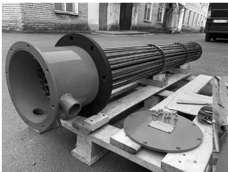
Блок для подогревания масла на 100 кВт
