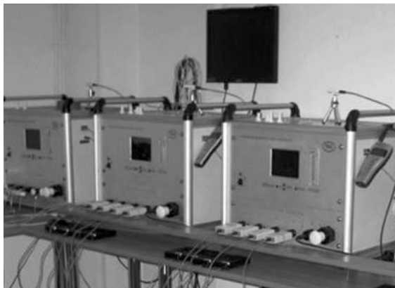
Рис. 1. Калибровочный центр, оборудованный группой генераторов ТКА-ГВЛ-01
