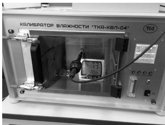
Рис. 3. Калибратор влажности «ТКА-КВЛ-04-1» с установленным зондом эталонного термогигрометра
